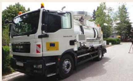
Vozilo za odvođenje kanalizacionih i otpadnih voda na Cetinju
